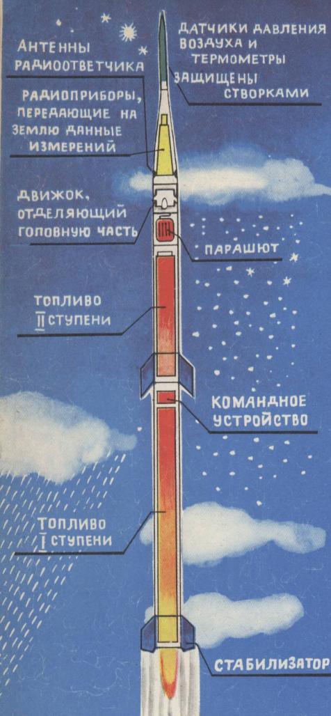
Вот такую метеоракету запускают каждую среду на острове Хейса. За час, который она проводит в полете, ракета поднимается на высоту до 90—100 километров. Возвращается она на парашюте. В капроновом шнуре, на котором подвешена головная часть ракеты, спрятана антенна, посылающая на землю радиосигналы.
