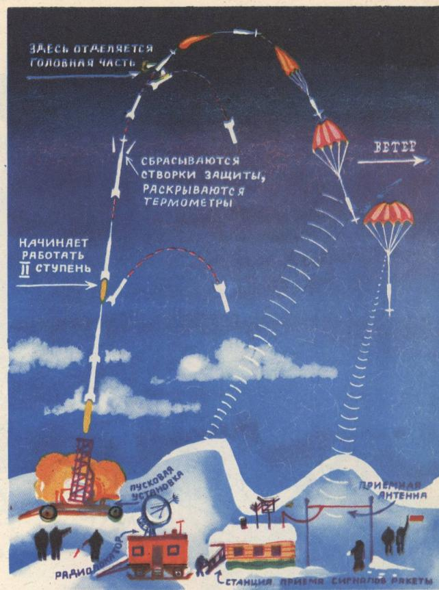
На этой схеме показано, как работают установки на станции ракетного зондирования атмосферы на острове Хейса во время полета ракеты.
